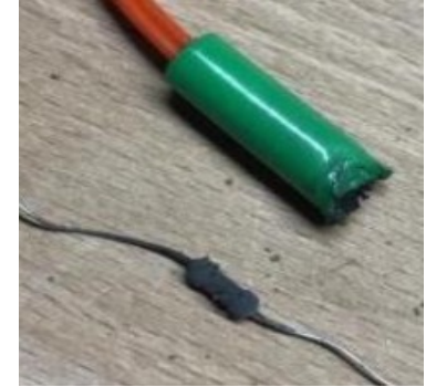
Ateşlenmiş bir elektrikli funye ve test sırasında yaktığımız bir direnç
